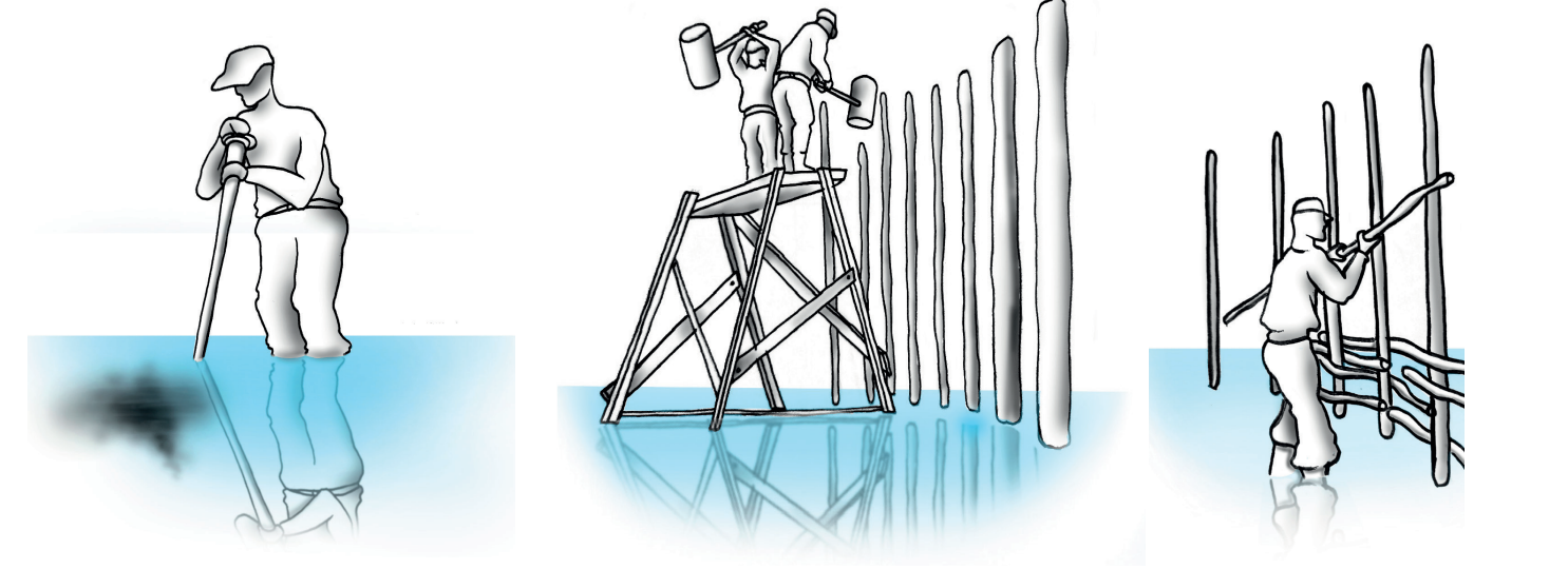
Le tracage de la pêche avec une pince Cognage pour planter les troncs d'épinettes Tendre la pêche ou Poser la fascine
