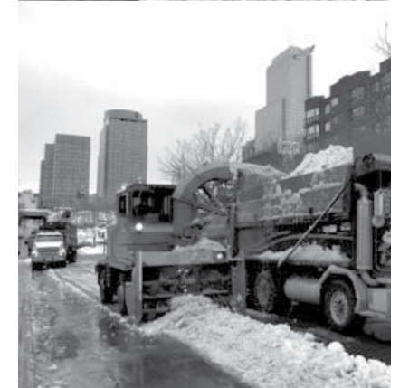
7 Une souffleuse mange et régurgite la neige dans un camion
